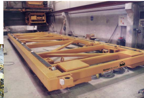
Geräuschlose Verdichtung von Fertigteilen mit dem Vibrationstisch Serie GyroShake
