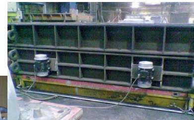
Verdichtung von Beton an einer Stahlschalung mit Elektro-Außenvibratoren Serie NEG
