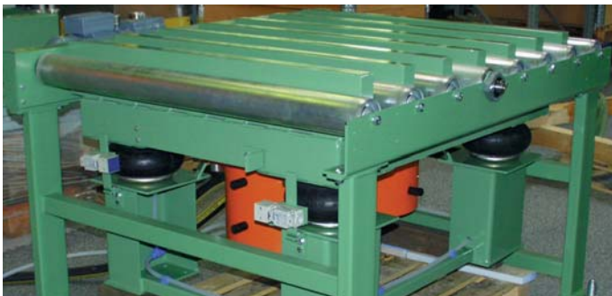
Verdichten von Formsand in Gießereiformen
