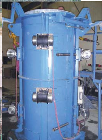
Elektro-Außenvibratoren Serie NEG an einer Rohr-Form
